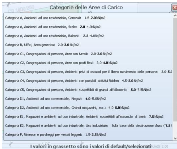
Modellatore Edifici - Categorie delle Aree di Carico dei Solai
