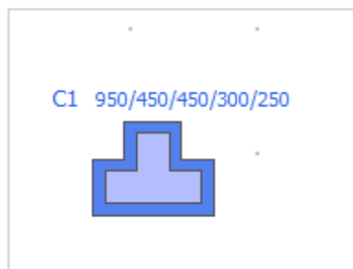
Inserimento del pilastro a T incamiciato C1
